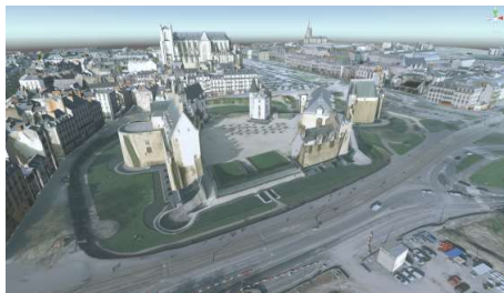
Absence de géométries (murs d'enceinte du château des Ducs de Bretagne) - extrait de [SL15]
